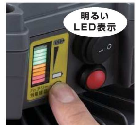
バッテリー残量インジケータ ボタンを押すと、明るいLED 表示で残量を確認できます
